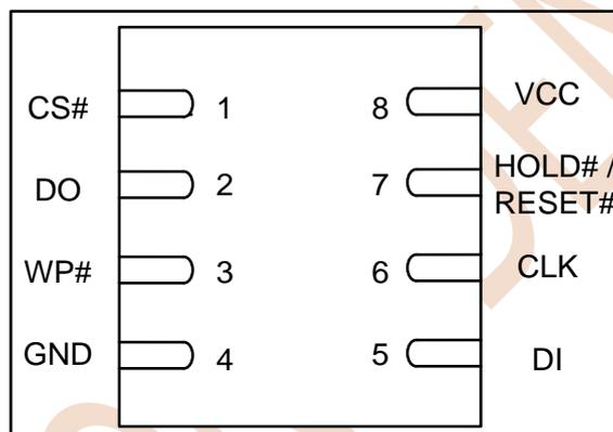
Figure 3.2 DFN8 (5\*6 mm)
