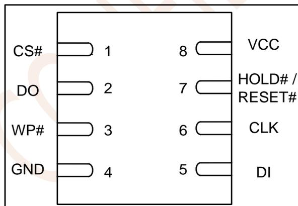
Figure 3.2 DFN8 (6\*8 mm)
